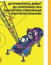
Робота крана поблизу лінії електропередач (в положенні стропів в сторону ЛЕП) до найближчого преводу має бути не менше 30 м. Роботи повинні проводитися з обгородженням нараді допуску спеціальної форми.
