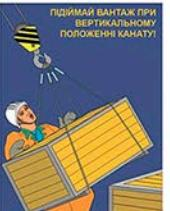
Щоб уникнути травмування при проведенні стропальних робіт, необхідно піднімати вантаж тільки при вертикальному положенні вантажо-занурювальних стропів із застосуванням спеціальних відстиков.
