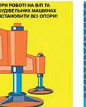
Під час проведення вантажних робіт використанням автомобільних стропових кранів, необхідно встановити упори на рівній площині для стійкості спецтехніки.
